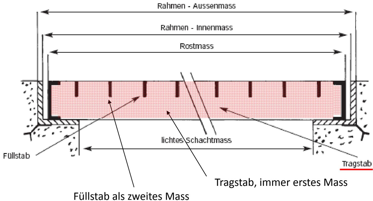
d.h. **1030** x 480 mm dass 1030 mm die Tragstabrichtung ist
