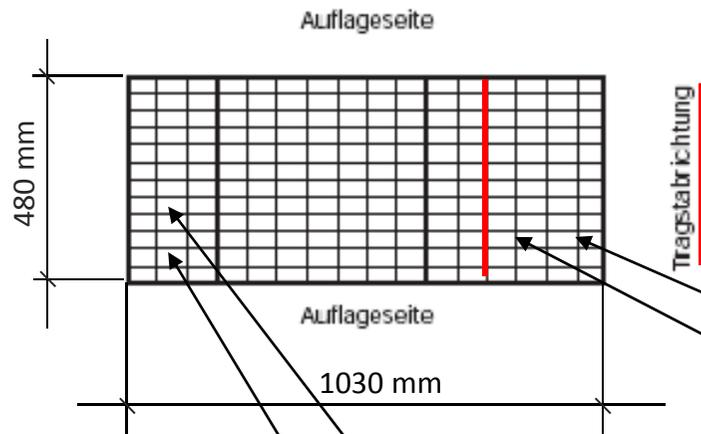
Bsp: MW **30/10** mm erstes Mass 30 mm ist Tragstababstand also **480** x 1030 mm
